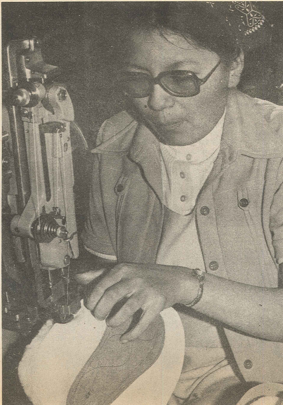
La «Adler-Pleater» sert à assembler l'empeigne et la partie-pied. La semelle double, comme le montre l'illustration ci-dessus, protège la chaussure, et en double la longévité.
